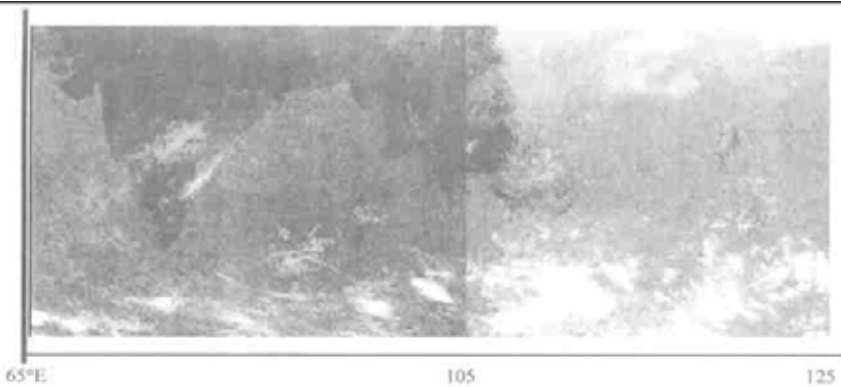
图 2 原始图像投影后直接拼接的结果(只取了图 1 中的部分图像)
