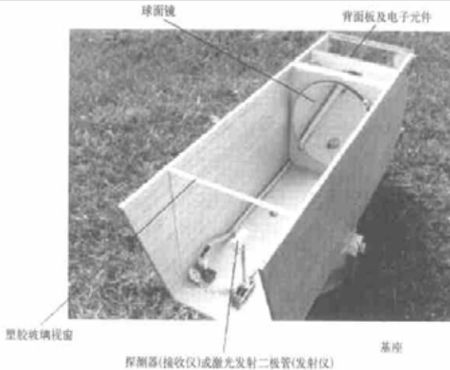
图 1 LAS 仪器内部构造
