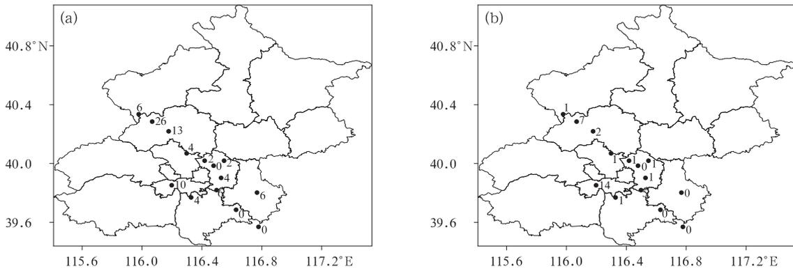
图2 北京市高速公路道面结冰次数空间分布 (a)外车道, (b)内车道
