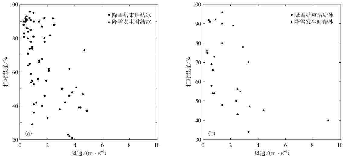
图8 北京高速公路降雪发生道面结冰时的风速和相对湿度 (a)外车道, (b)内车道
