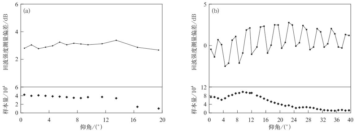
图2 X-PAR各仰角回波强度测量偏差随仰角变化廓线
